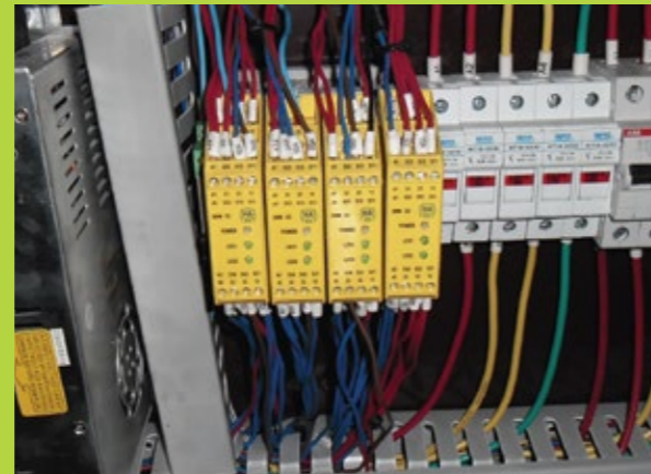
Quatro reles de segurança para as proteções móveis e os botões de emergência
